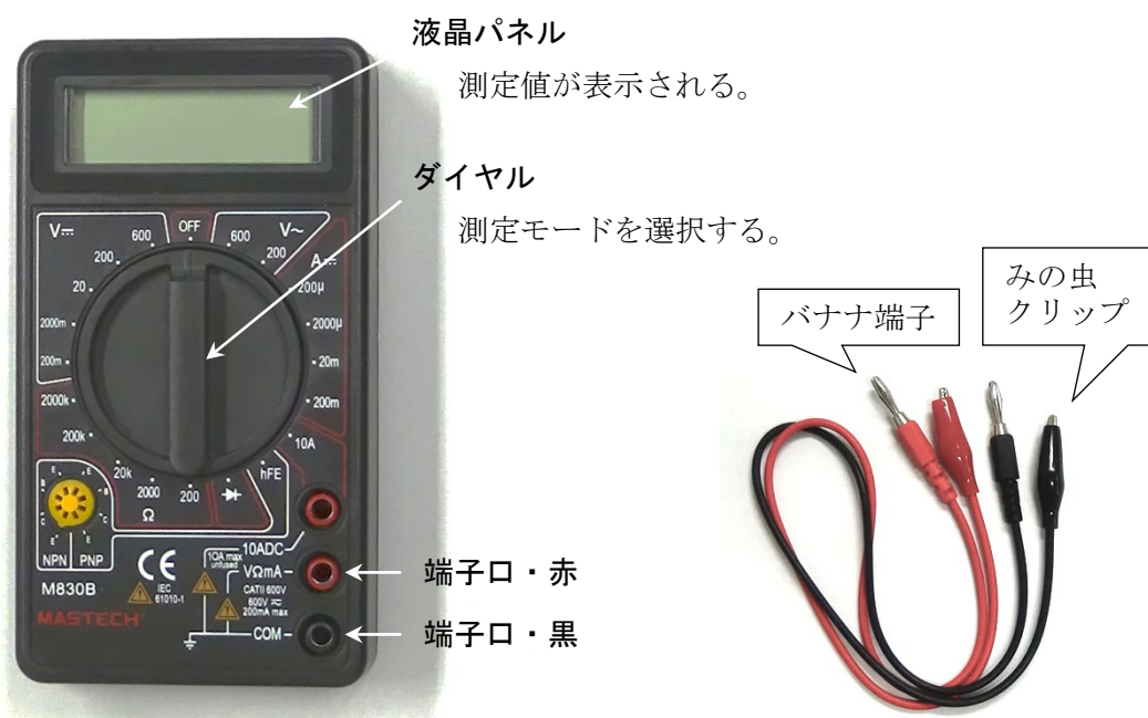
図3. デジタルマルチメーター(左)と使用するケーブル(右)
